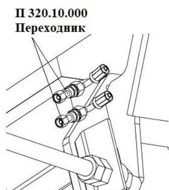
Рисунок 16 – Подсоединение гидросистемы погрузчика к гидросистеме трактора
