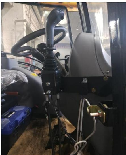
Установить разъем на провод джойстика и соединить с разъемом провода L=0,2 м.
