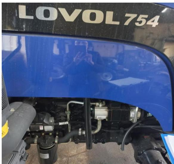
Трубка от масляного насоса к распределителю трактора
