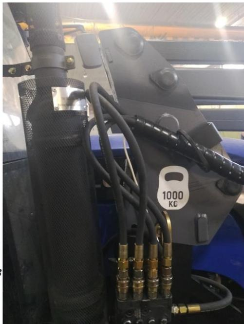
Рисунок 3 – Установка гидрораспределителя:
