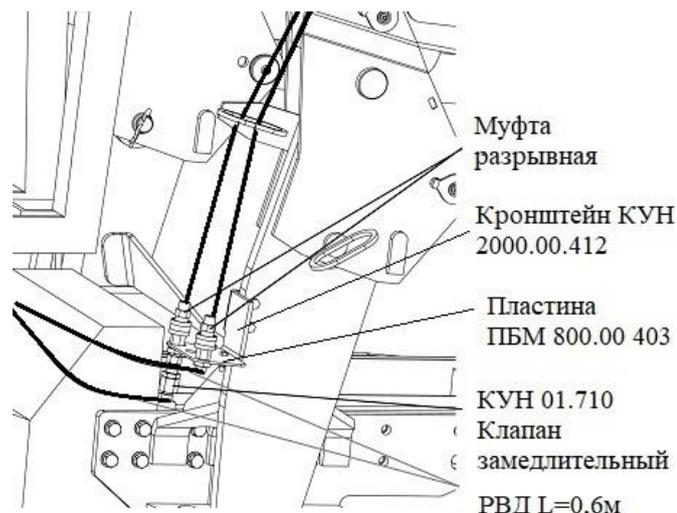
Рисунок 20 – Подсоединение гидросистемы поручика к гидросистеме трактора
