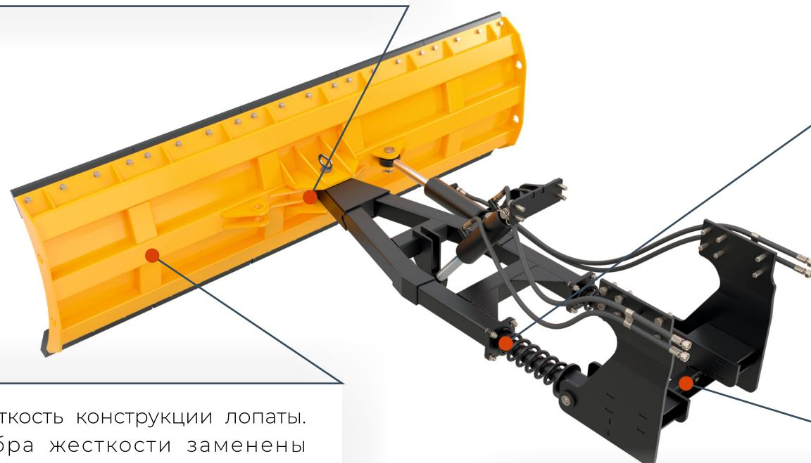
Повышена жесткость конструкции лопаты. Листовые ребра жесткости заменены продольными и поперечными швеллерами, связанными между собой и образующими единую рамную конструкцию.
