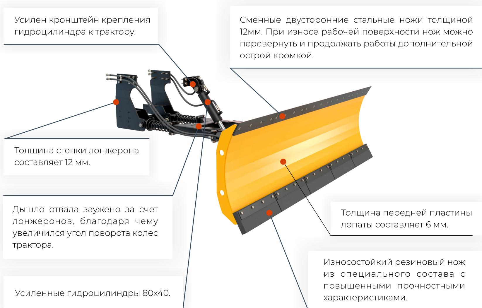
Изменен принцип фиксации лопаты в крайнем положении ( $30^\circ$ ). Она самостоятельно упирается в специальный ограничитель, что позволяет отказаться от ручной фиксации и значительно снижает нагрузку на гидравлику.
