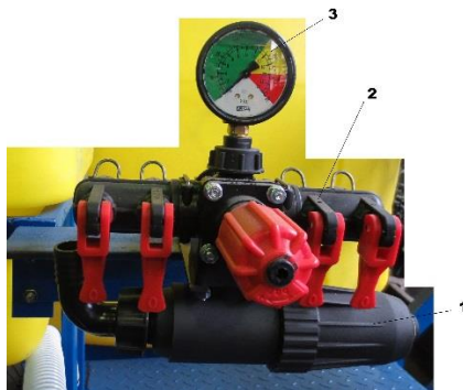
Рис.10 Регулятор-распределитель с напорным фильтром.
