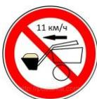
**Не допускается движение груженого агрегата со скоростью свыше 11 км/ч.**
