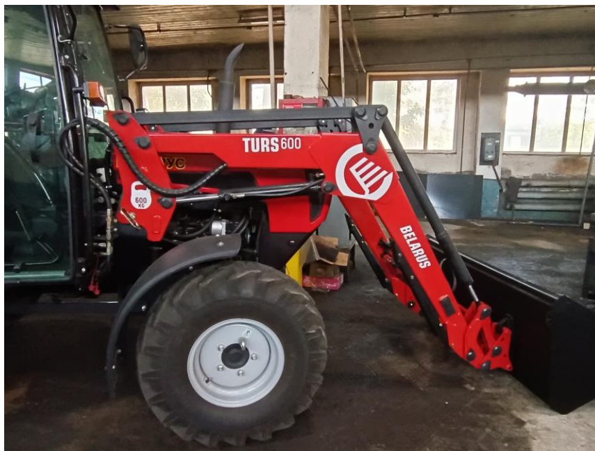
Фото 1 Общий вид погрузчика КУН(ТURS)-600 с ковшом 0,22м 3
