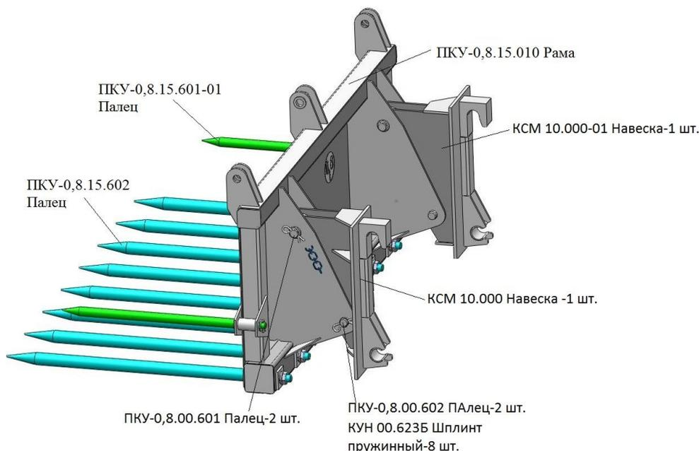
Вилы без прижима состоят из рамы, в которой крепятся восемь нижних пальцев и два боковых пальца. Вилы навешиваются на погрузчик ПБМ-1200-0 при помощи навесок КСМ10.000 и КСМ 10.000-01, которые крепятся пальцами ПКУ-0,8.00.601, ПКУ-0,8.00.602 и шплинтуются шплинтами пружинными КУН 00.623Б.
