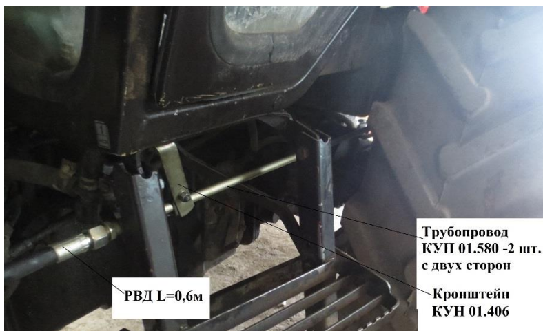
Фото 4 Установка трубопроводов к задней навески трактора
