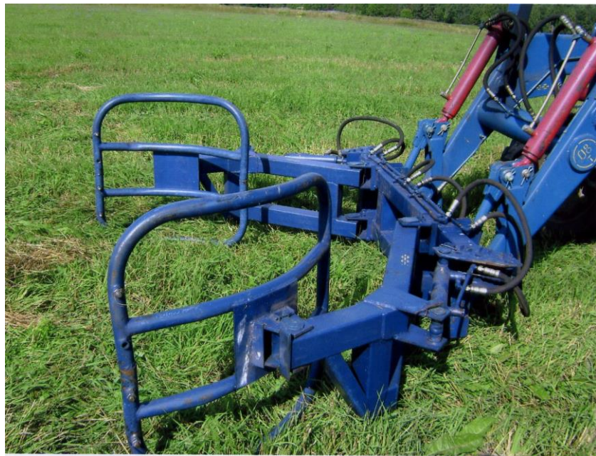
Положение захвата для погрузки рулонов, находящихся в вертикальном положении
