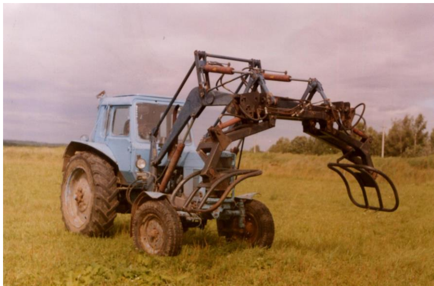
Положение захвата для погрузки рулонов, находящихся в горизонтальном положении
